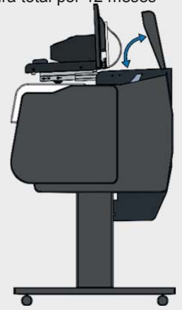
Acceso a los tanques
